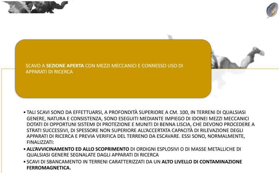
**SCAVO A SEZIONE APERTA CON MEZZI MECCANICI E CONNESSO USO DI APPARATI DI RICERCA**
